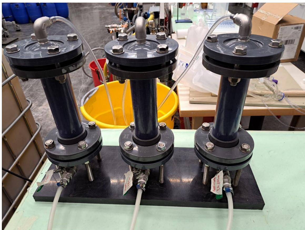
Kuva 1. Bio- ja aktiivihiilisuodatuskokeessa käytetty kolonnilaitteisto.
