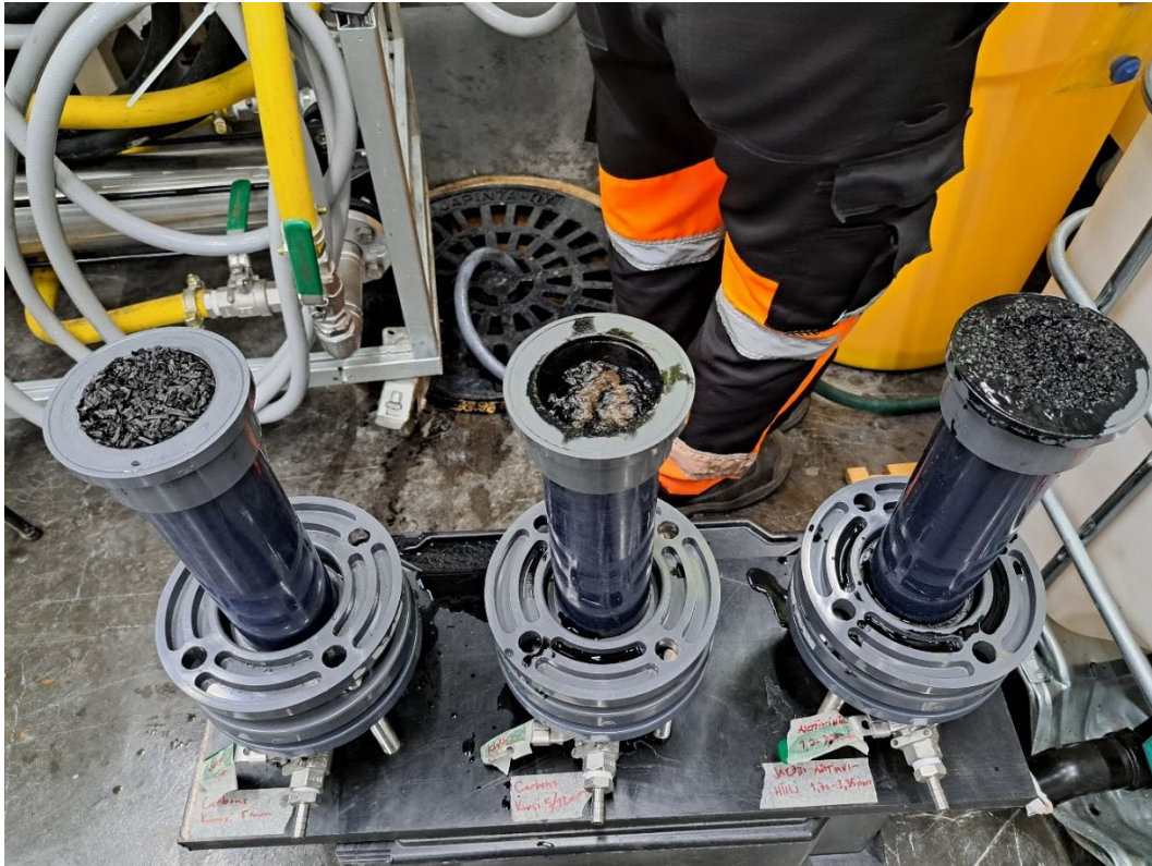
Kuva 11. Kolonnien yläpäätkä reikälevyjen poiston jälkeen.
