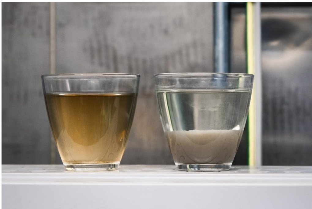
Kuva 4 Elektrokoagulaation visuaalinen tulos ennen ja EC-käsittelyn jälkeen
